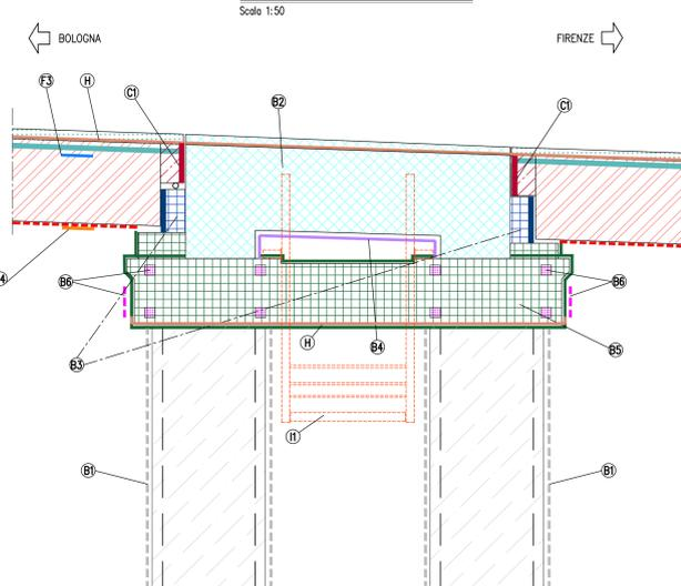
SEZIONE LONGITUDINALE TIPO SU PILA - Sez. A-A
