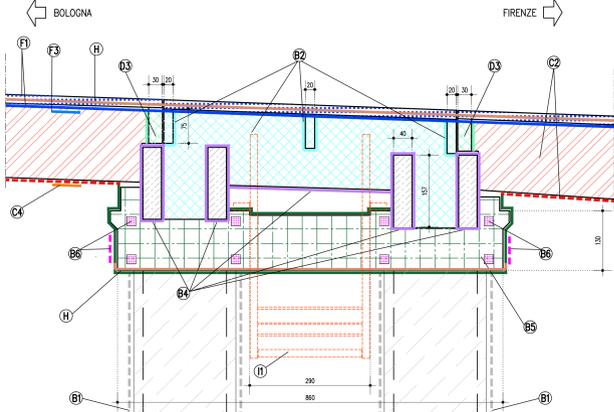
SEZIONE LONGITUDINALE TIPO SU PILA - Sez. B-B
